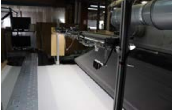
成形した不織布をカメラで撮影する工程
