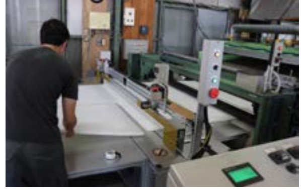
成形した不織布をカットする工程
